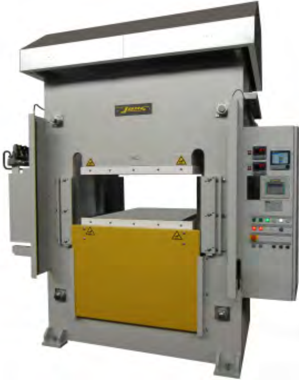
LAP 450 als Jochpresse ausgelegt, Pressfläche 1000 x 1000 mm, elektrisch beheizt, Betriebstemperatur 300°C, Hydraulikaggregat an der Seite
