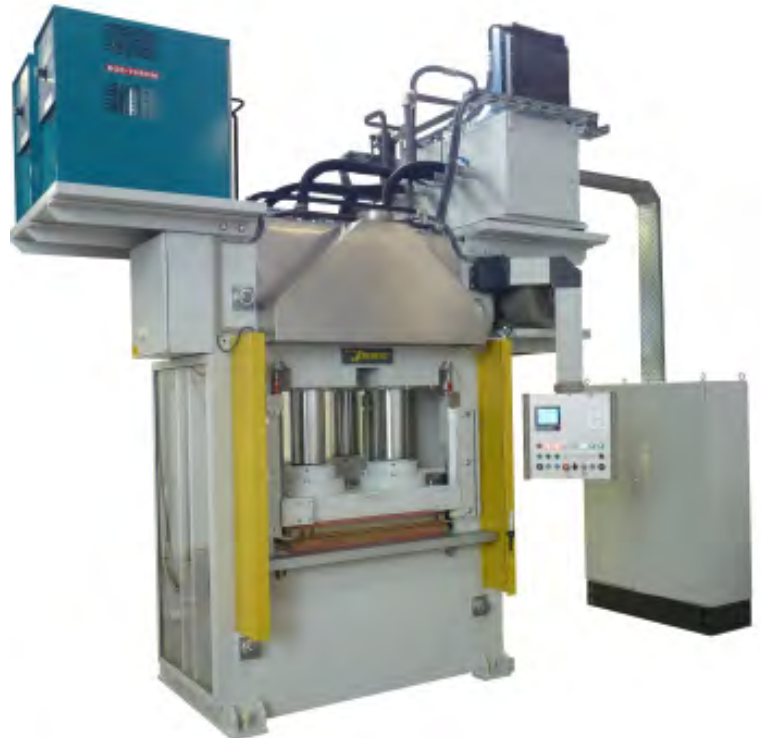
LAP 500 als Jochpresse ausgelegt, Pressfläche 1000 x 1000 mm, thermoölbeheizt, Betriebstemperatur 230°C, Hydraulikaggregat und Temperiergeräte auf dem Pressenhaupt
