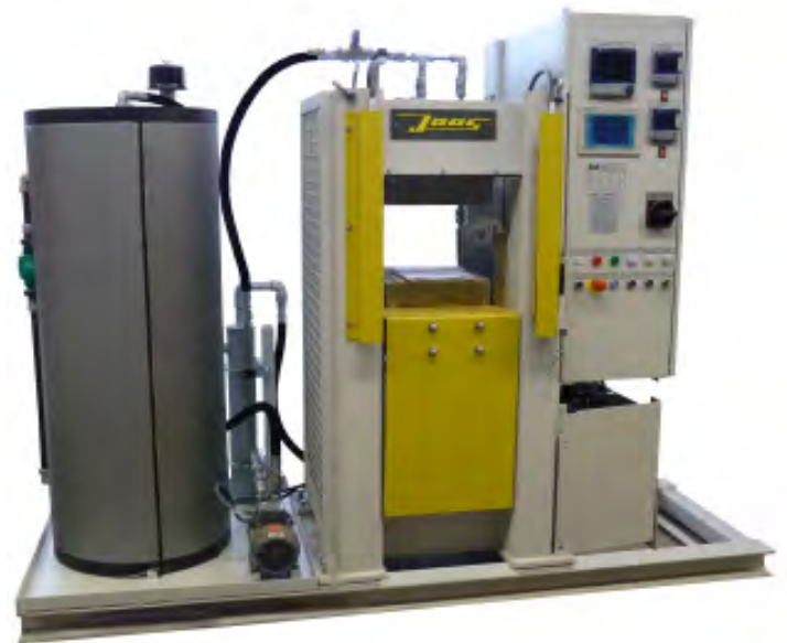
LAP 30, Pressfläche 300 x 300 mm, elektrisch beheizt, Betriebstemperatur 350°C, Heizplatte mit darunterliegendem Kühlfeld, gespeist über Wassertank
