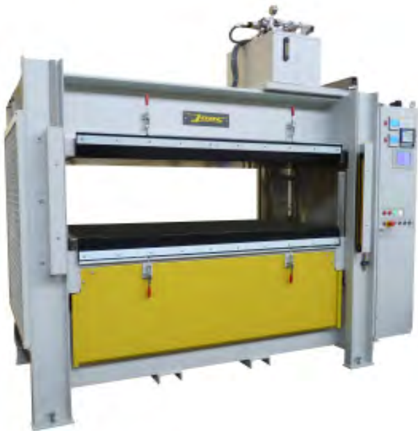
LAP 100, Pressfläche 1800 x 1000 mm, elektrisch beheizt, Betriebstemperatur 250°C, Hydraulikaggregat auf dem Pressenhaupt
